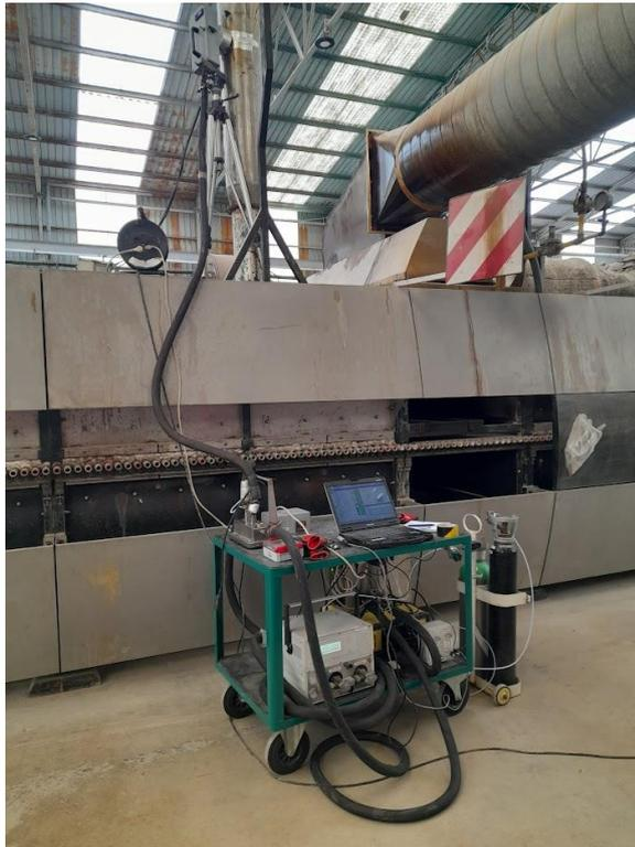
Figura 30. Imagen del montaje de los equipos utilizados para la monitorización de la emisión de las baldosas.
