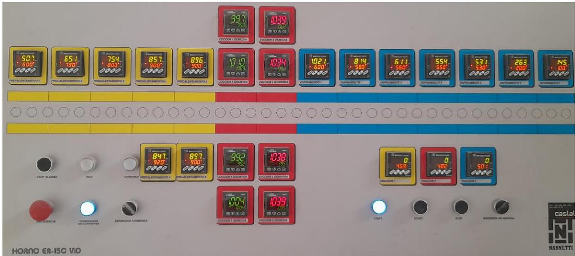
Figura 18. Imagen del panel de control del horno Nanneti, instalado en la empresa Vernis.
