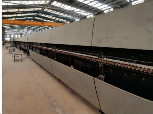
Figura 12. Imagen del horno eléctrico fabricado por System Ceramics. Por cortesía de Levantina.
