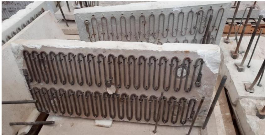
Figura 25. Imagen de los módulos de calentamiento utilizado en el horno eléctrico.
