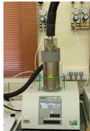
Figura 6. Fotografía del equipo de análisis térmico utilizado para determinar el calor de reacción.
