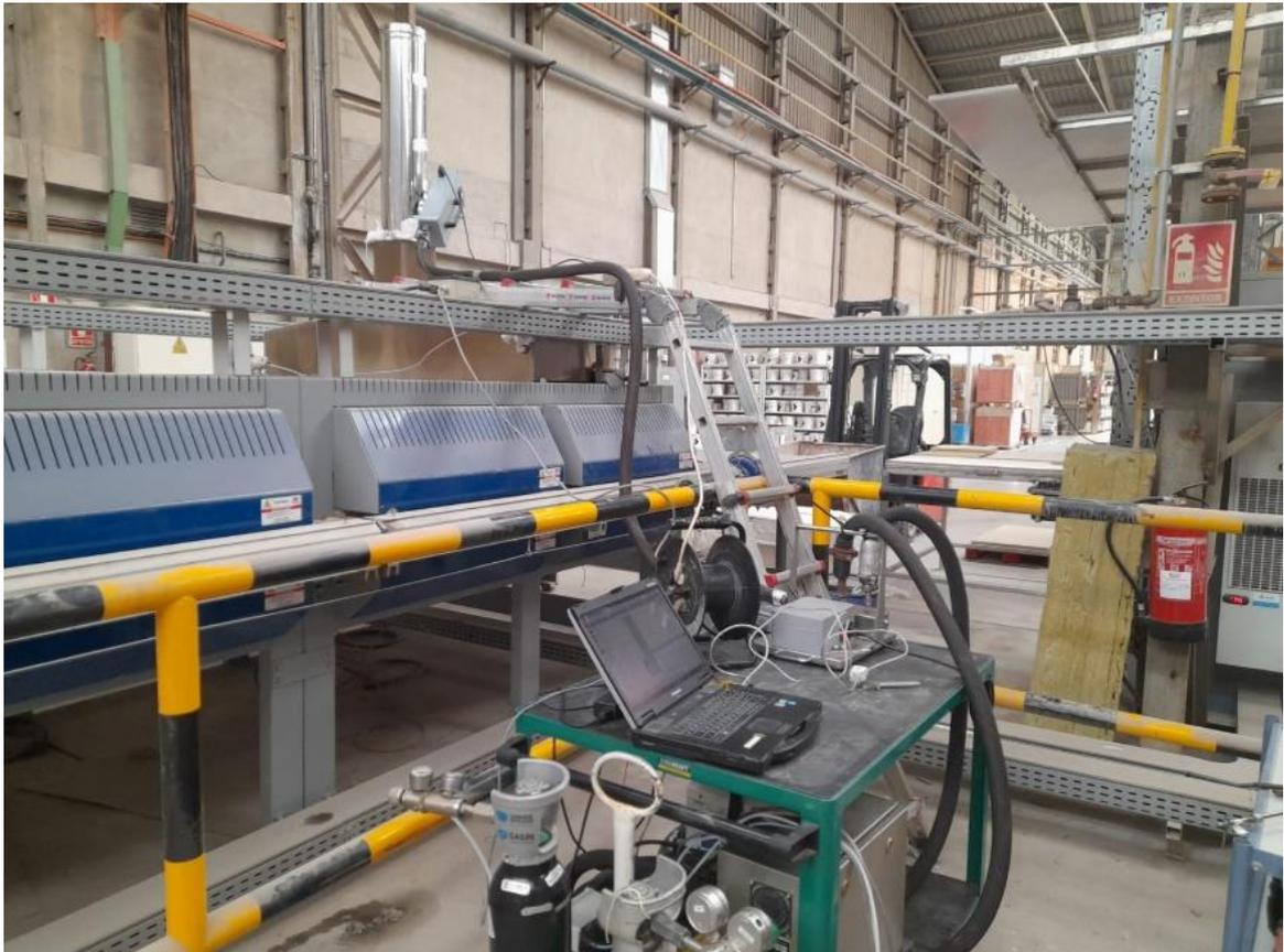
Figura 24. Imagen del montaje de los equipos utilizados para la monitorización de la emisión de las baldosas.
