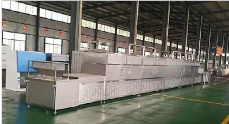
*Figura 3 Sistema de secado por microondas para cerámica [21]*
